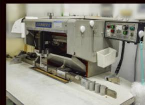
**P 穴明機** (大西機械製作所) 2ツ穴まで対応、サブ機
