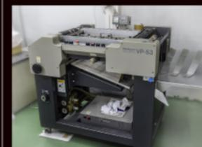
**Q ミシン機** (Horizon VP-53) ミシン、マイクロミシン加工 筋入れ
